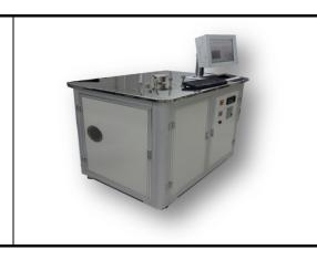
用于气体分析仪检测氦气而 对被件腔体进行真空检漏的 精密仪器。
